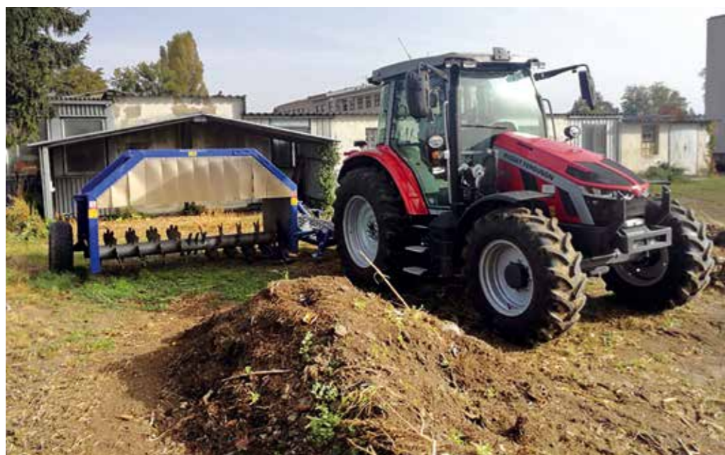
Obr. 1: Souprava pro překopávání pásové zakládky kompostu
