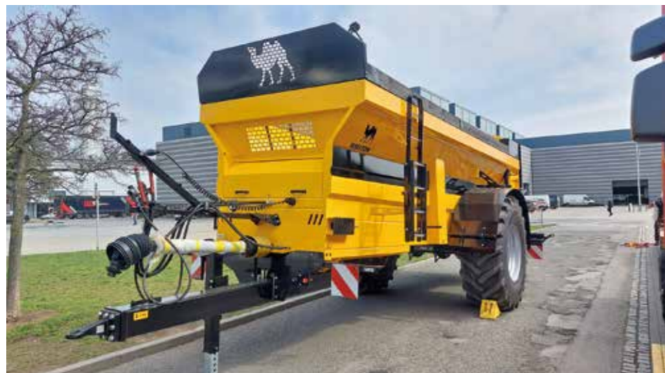
Kombinované rozmetadlo Wielton Agro na chlévskou mrvu a vápno.
