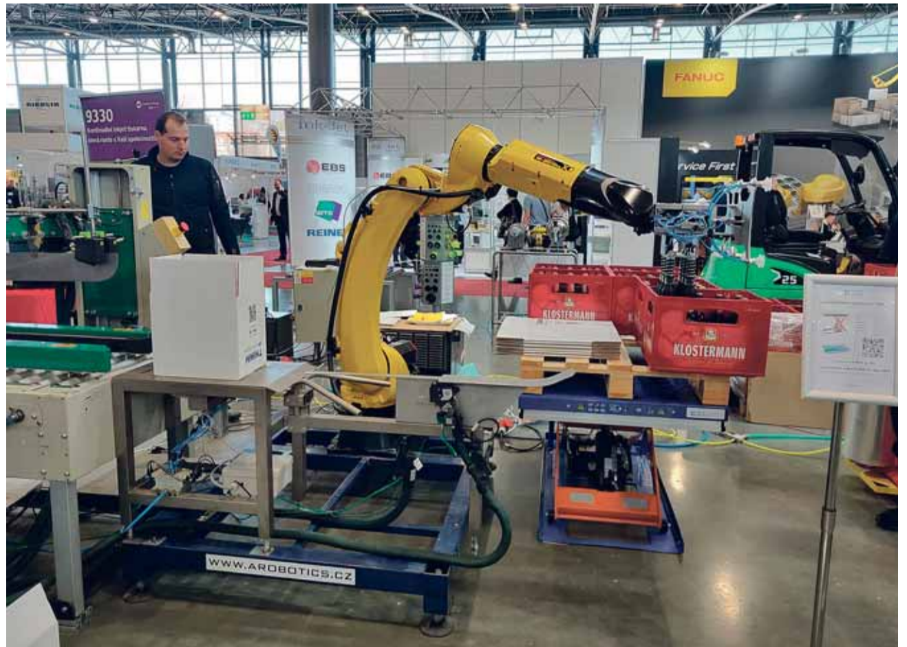
Využití robotu FANUC při manipulaci s přepravkami
