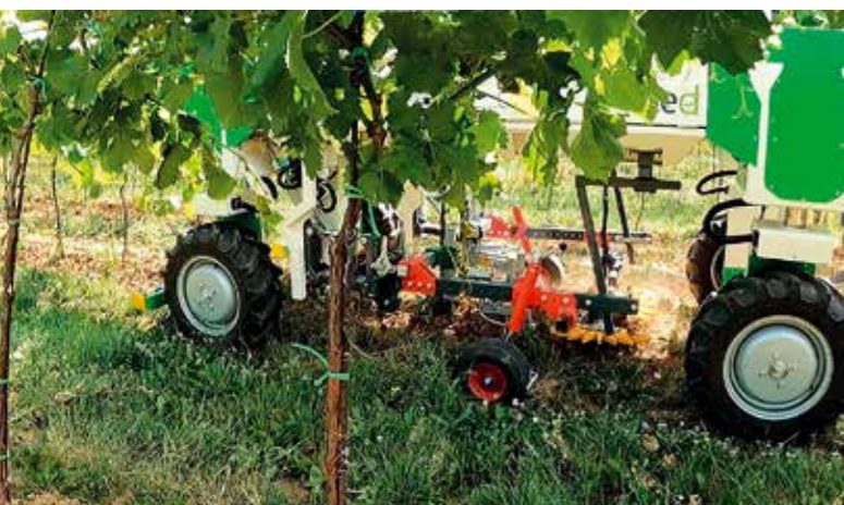
Autonomní robot NAI0 TED vybavený nářadím při údržbě příkmenného pásu ve vinohradu
