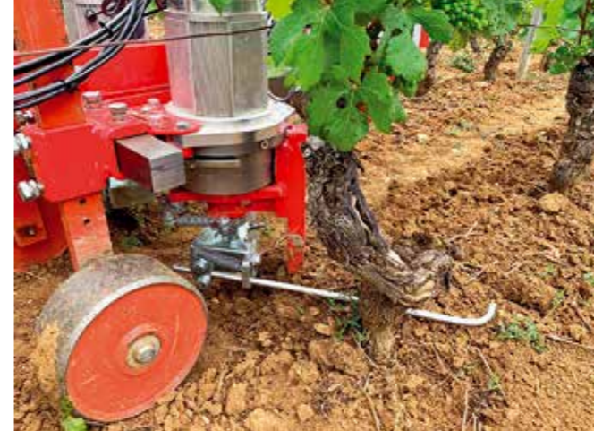
Elektrický motor Boisselet EVOLT® umožňuje velmi přesné nastavení pro precizní údržbu příkmenného pásu
