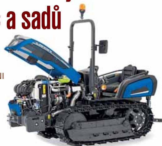
Nový super kompaktní motor KOHLER KDI 2504 STAGE V má obsah 2,5l
