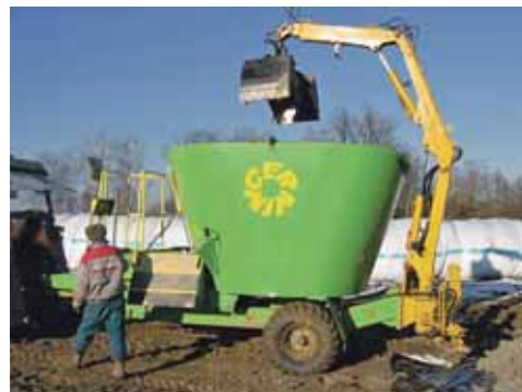
Vertikální krmný vůz vybavený hydraulickou nakládací rukou.
