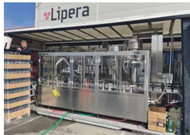
Mobilní plnicí linka firmy Lipera
