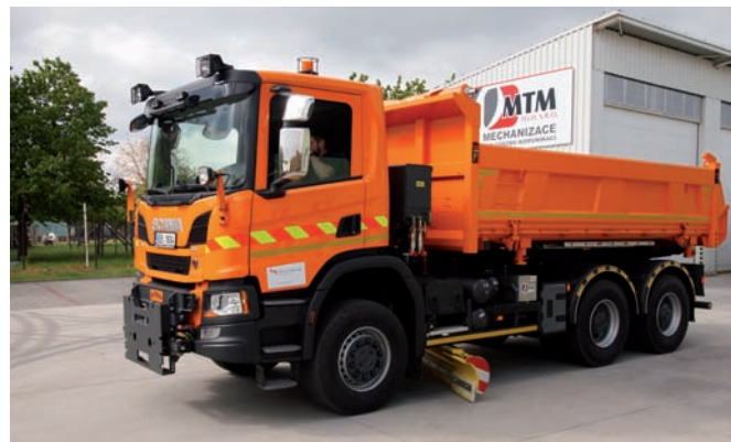
Příklad mezinápravového sněhového pluhu MP 25 - 35 typu Alpha model HMP montovaného na vozidlo Scania 6x6 SÚS Pardubického kraje
