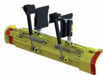
Ilustrační schematický náčrt mezinápravového sněhového pluhu typu MP - Alpha
