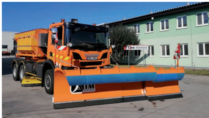
Příklad mezinápravového sněhového pluhu MP 25 - 35 typu Alpha model HMP montovaného na vozidlo Scania 6x6 SÚS Pardubického kraje společně s vpředu neseným teleskopicky vysouváním sněhovým pluhem DP2L 38-48
