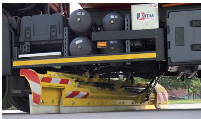
Ve stažené / transportní / pozici nepřesahuje radlice obrys nosného vozidla, v pracovní pozici lze potom okrajové výsuvné části plynule vysouvat
