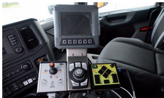
Na levé straně středového stojanu v kabině řidiče integrovaný ovládací pult mezinápravového pluhu MP
