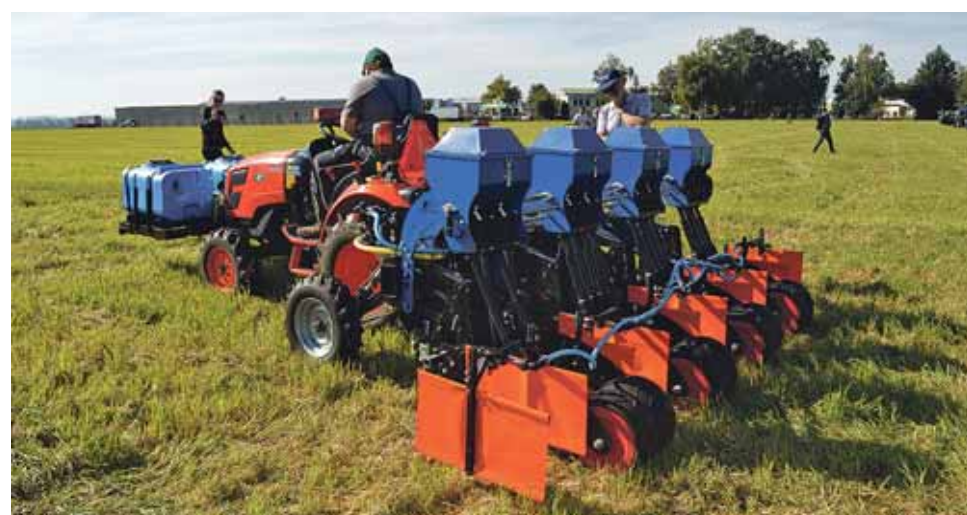
Studie technologie pro zakládání podplodiny v kukuřici s pásovou aplikací herbicidu a aplikací hnojiva.
