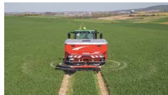
Nesené rozmetadlo AXIS-H 50.2 EMC+W vybavené automatickou korekcí pracovního záběru AXMAT.
