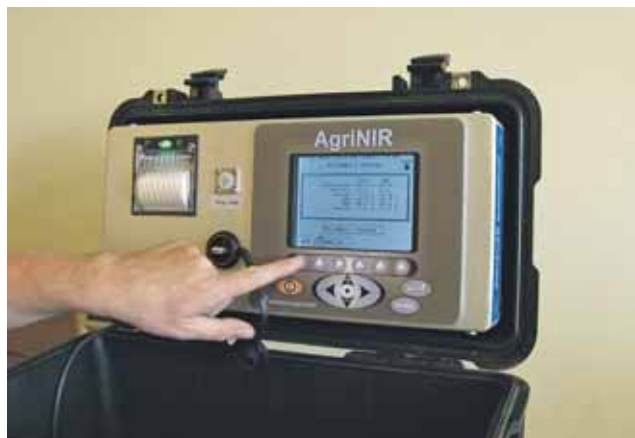
Přístroj AgriNIRS pro analýzu čerstvé hmoty
