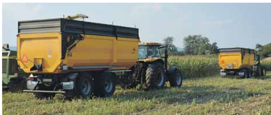
Kónický tvar korby u návěsů Wielton – Agro je nejen moderní, ale především zvyšuje plynulost vykládání materiálu.
