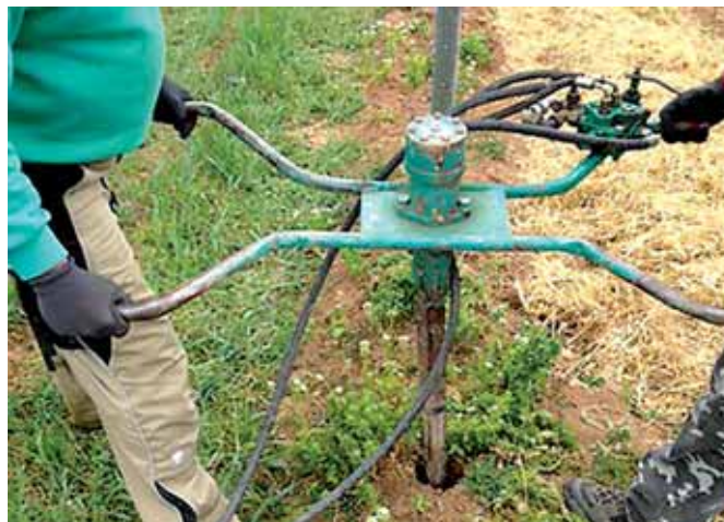
Obr.2: Přenosný vrták s pohonem od hydromotoru
