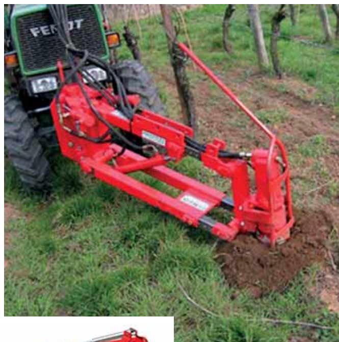
Obr.3: Traktorové nesené vrtáky
