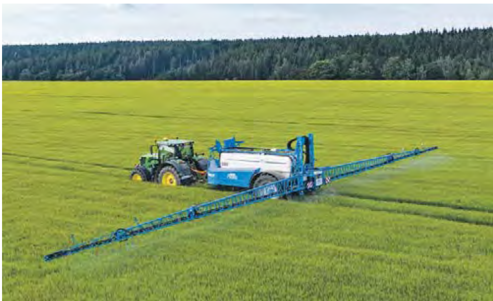
Návěsné postřikovače představují nejpočetnější část vyrobených strojů. Varianta Mamut XL nabízí nádrž o velikosti 7000 l a 8000 l.
