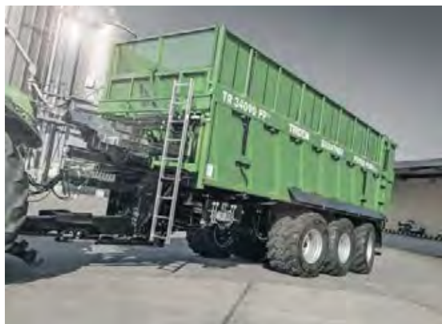
Tridemový návěs TR 34090 POWER-PUSH plus+ s výtlačným čelem o celkové hmotnosti 34 tun
