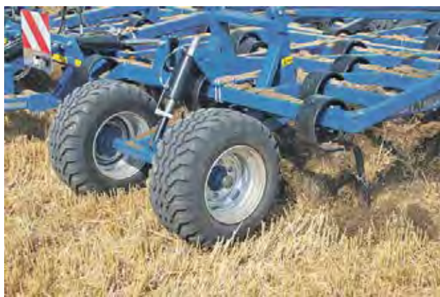
Hydraulicky nastavitelná hloubka zpracování půdy - za jízdy z kabiny traktoru
