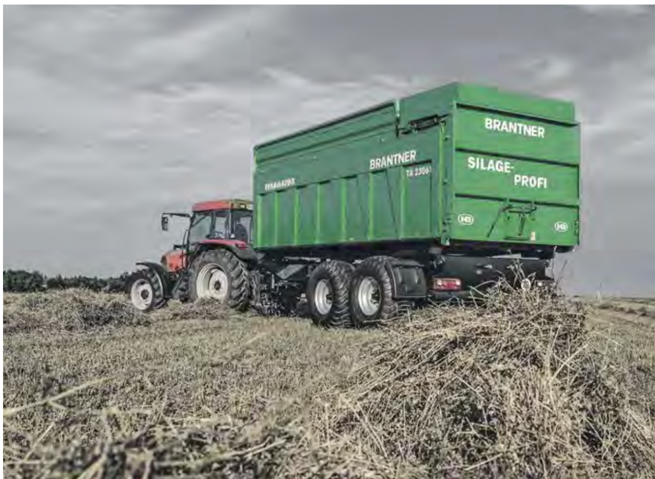
Tandemový návěs TA 23061/2 XXL s celkovou hmotností 23 tun vybavený korbou typu STABILATOR
