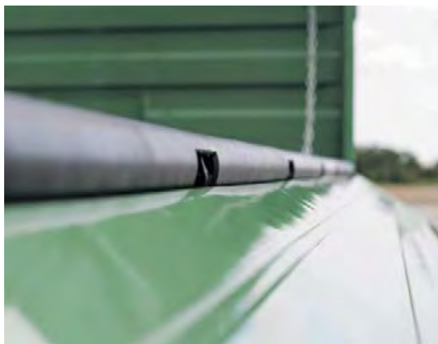
Ložná plocha je hraněná ze všech čtyř stran se samočisticím efektem
