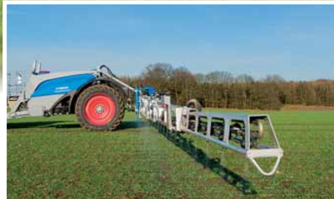
Celohliníková ramena v robustním provedení, uložená na paralelogramu – optimální poměr malé hmotnosti a vysoké stability a životnosti ramen. Systém ABC pro automatické proaktivní vedení ramen a vypínání každé trysky jsou samozřejmostí.
