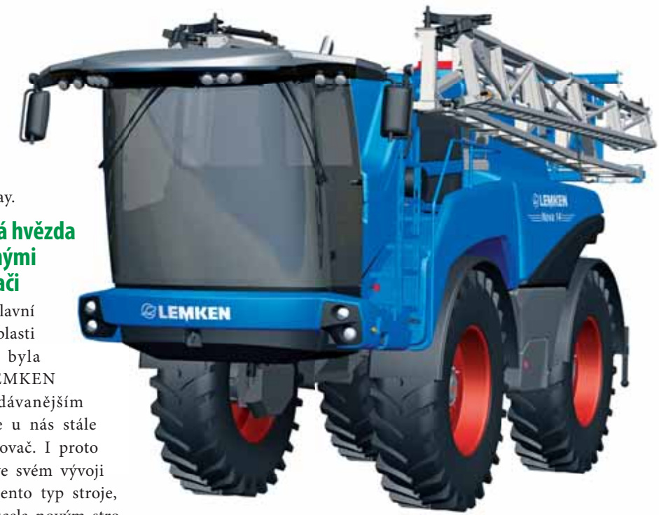
Nový samojízdný postřikovač LEMKEN Nova s nádrží o objemu až 7 200 l a záběru ramen od 24 do 39 metrů, roztahovací nápravy a možnost zvýšení světél výšky až na 1,60 m. Nova vstupuje na trh s cílem splnit i nejnáročnější požadavky zemědělců.
