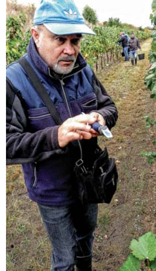
Milan Sedláček a měření cukrnatosti refraktometrem
