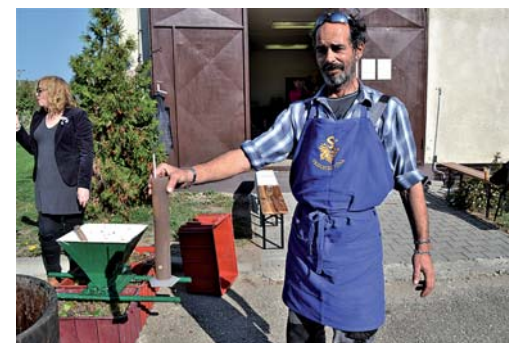
Měření cukrnatosti za pomoci moštoměru
