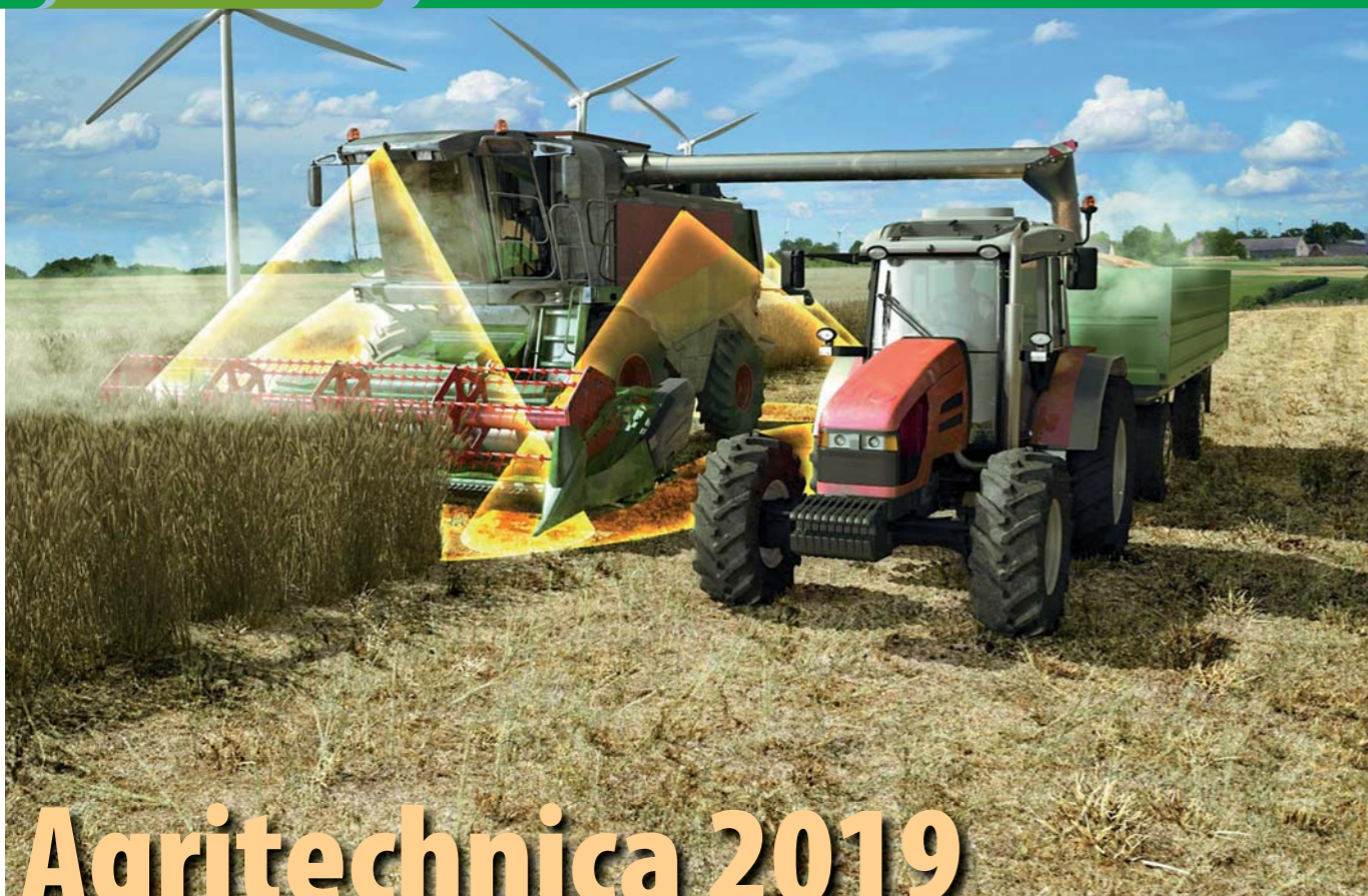
Druhá generace inteligentního systému prostorového zobrazení ProViu 360 poskytuje řidiči panoramatický pohled na stroj z ptáčích perspektiv v HD rozlišení na dotykovém displeji.
