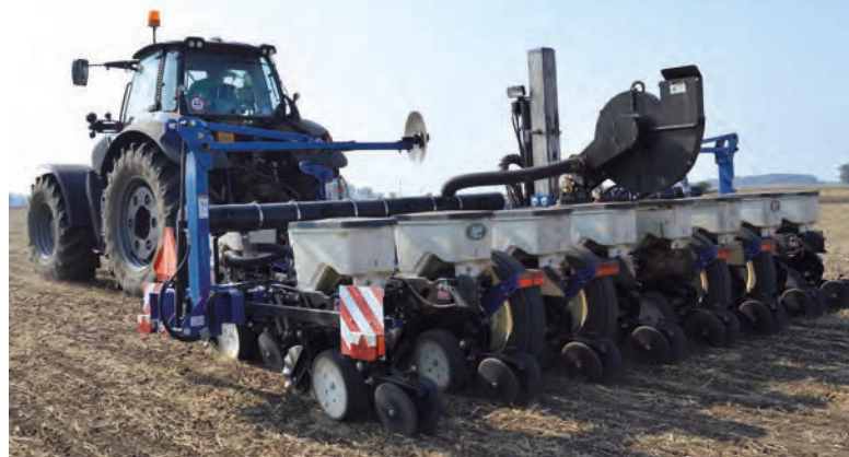
Secí stroj Kinze 3500 je jediný na trhu, který umožňuje rozteč řádků 37,5 cm.
