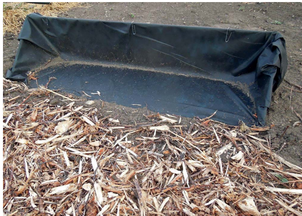
Obrázek 2 Záchytná kapsa pro měření půdního smyvu
