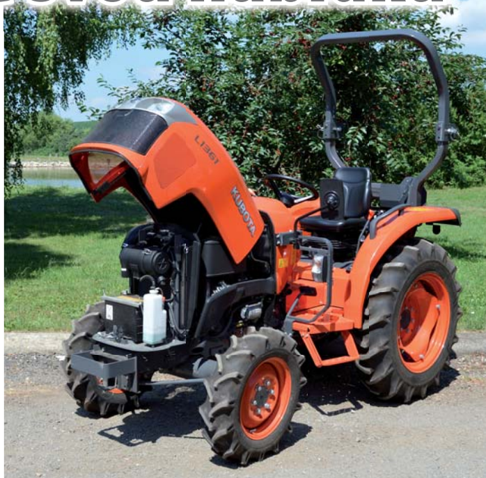
Servis i údržba jsou snadné díky otevírání kapoty pod velkým úhlem.
