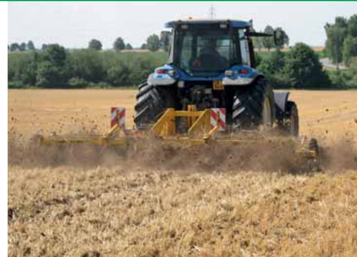
Claydon TerraStar je vhodný k agregaci s traktorem o výkonu alespoň 150 koní
