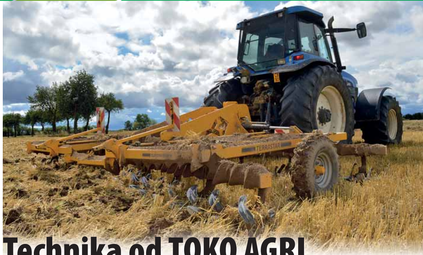
Claydon TerraStar kypří povrch půdy a zároveň nechává pevnou půdu pod úrovní zpracování
