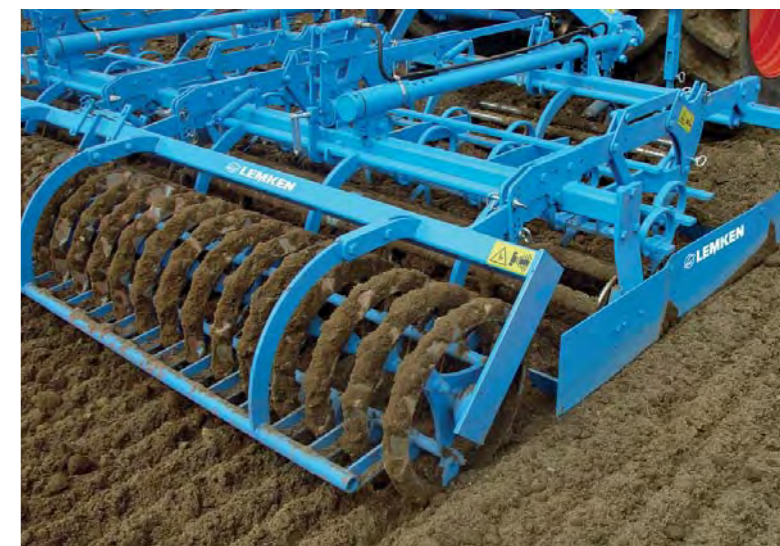
Kompaktor lze v poloneseném provedení (na obrázku) kombinovat se secím strojem Solitair 9 zavěšeným na zadní nápravu stroje
