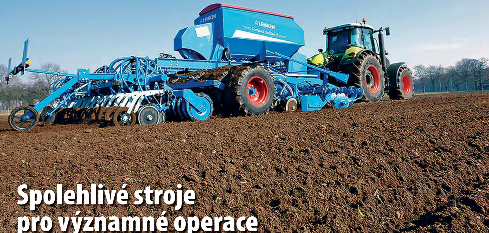
Secí stroje Compact-Solitair lze pro výsev řepky kombinovat jak s diskovou přípravou Heliodor (na obrázku), tak i rotačními bránami Zirkon.
