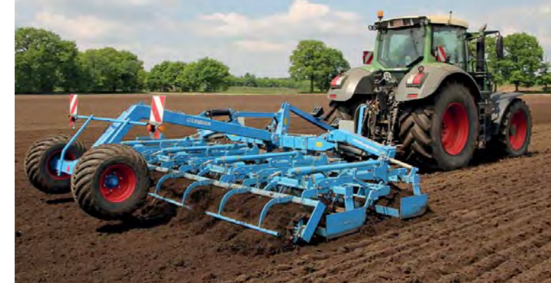
Pro precizní přípravu seťového lože před výsevem řepky doporučuje LEMKEN osvědčený System-Kompaktor.
