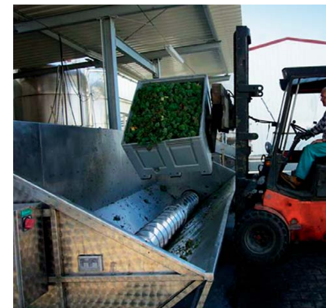
Obr. 1-4: Překlápěcí adaptér na vysokozdvizném vozíku
