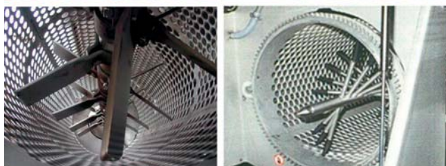
Obr. 2-5: Hřídele s prsty nebo rozšířenými lopatkami
