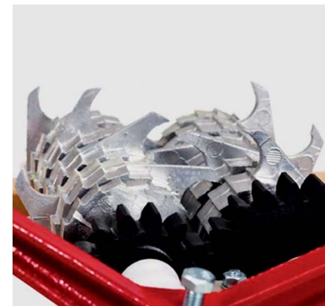
Obr. 2-1: Provedení drticích válců u drtičů hroznů
