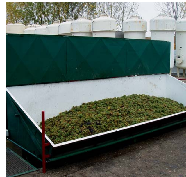
Obr. 1-1: Příjmová vana v ocelovém provedení s ochranným nátěrem
