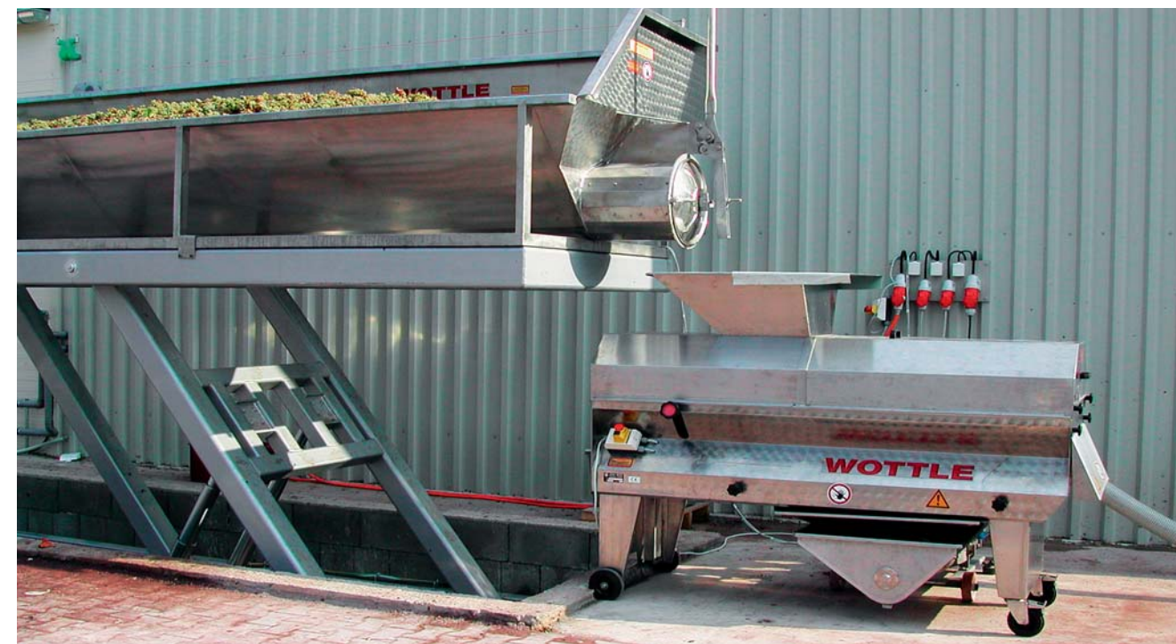
Obr. 1-7: Přesuvný transportní pás s hydraulickým válcem
