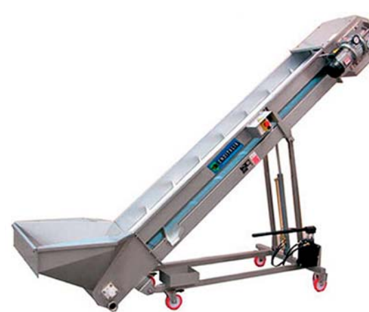
Obr. 1-7: Přesuvný transportní pás s hydraulickým válcem
