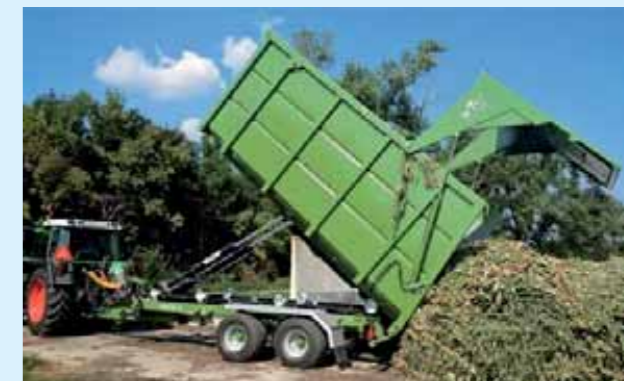
Nosič PORTÝR 10 s vanovým kontejnerem s hydraulickým otevíráním zadních vrat
