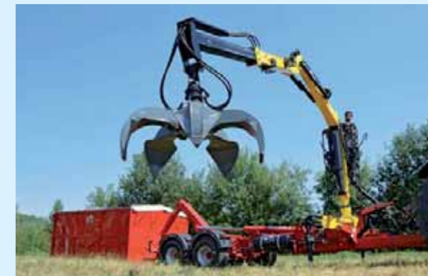
Nosič PORTÝR 8 vybavený hydraulickým jeřábem
