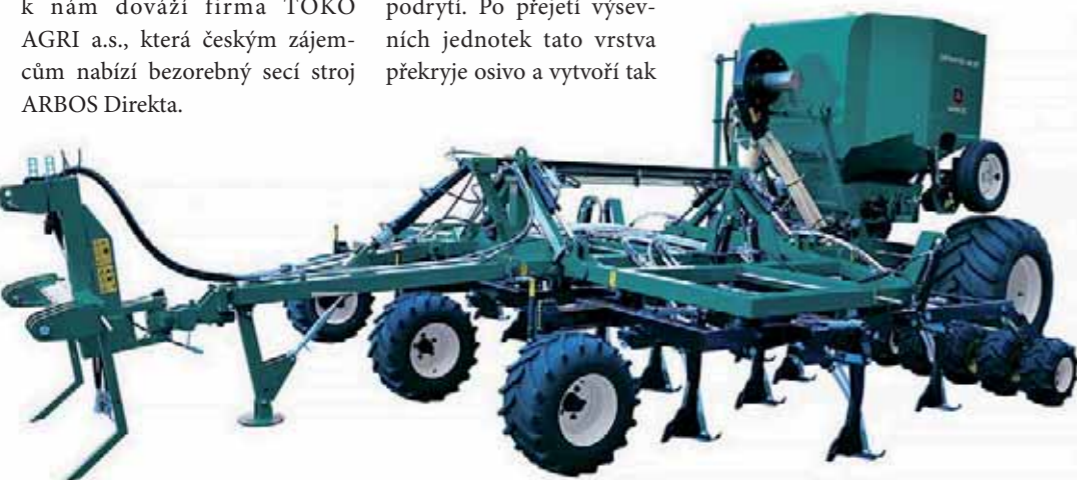
Secí stroj je ojedinelý zejména svými výsevními jednotkami, osazenými křídélky.
