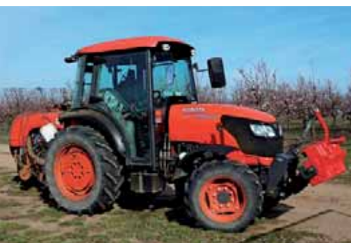
Kubota M8540 Narrow je pětaosmdesátikoňový silák, s čelním tříbodovým závěsem a dobrými tahovými vlastnostmi
