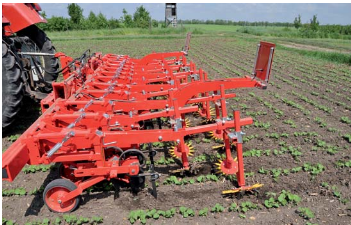
Dvanáctiřádková plečka Einböck CHOPSTAR pro zadní agregaci.
