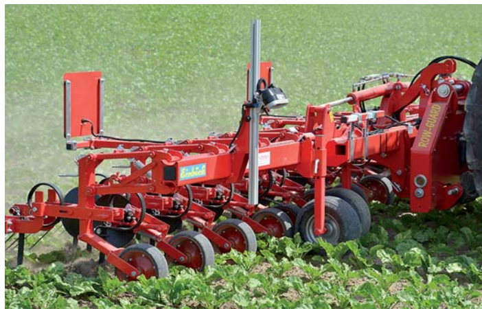
Kamerový navigační systém Einböck ROW-GUARD.
