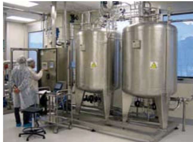
Obrázok 2: CIP stanica na sanitáciu technologických zariadení
