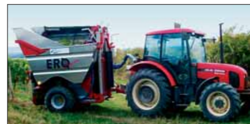
► Obr. 15-26: Návěsný sklízecí ústrojí hroznů
