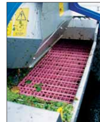
► Obr. 15-22: Perforovaný pásový dopravník
