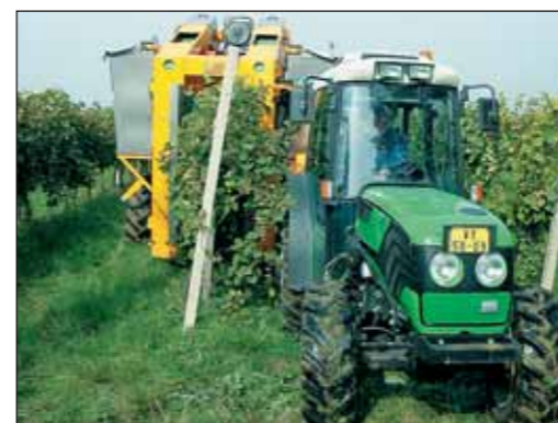
► Obr. 15-27: Návěsný sklízecí ústrojí hroznů
