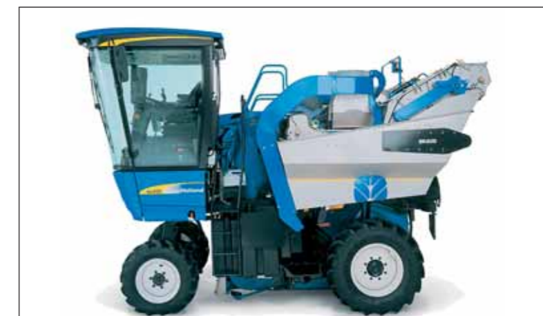
► Obr. 15-29: Samojízdný sklízecí ústrojí hroznů
