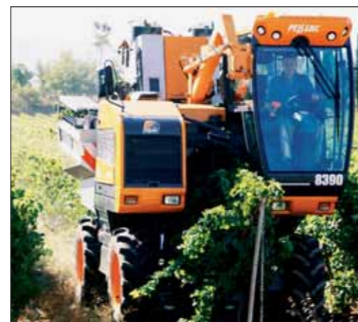
► Obr. 15-28: Samojízdný sklízecí ústrojí hroznů
