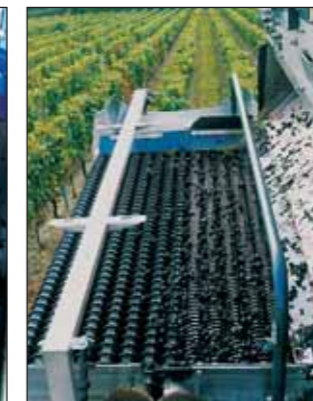
► Obr. 15-23: Dvojitý rotační rošt
