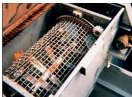
► Obr. 15-21: Válcová separační síta
