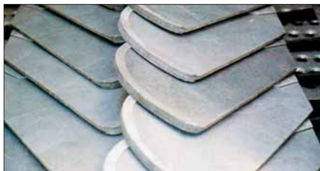
► Obr. 15-20: Záchytné ústrojí s otočnými clonami
